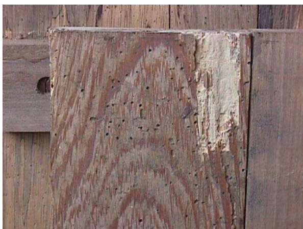
Madera de Lonchocarpus sp atacada por el insecto conocido como coquito polvoriento de los postes, Lyctus
