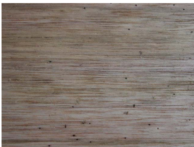
Madera de cedro con ataque de insectos de madera verde y hongos de pudrición blanca en bolsas
